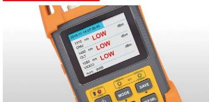
Le **PROLITE-57** est un mesureur de puissance optique PON pour FTTH portable et de haute qualité. Il est capable de mesurer les trois longueurs d'onde (1310, 1490 et 1550 nm). L'utilisation simple et les mesures précises font du **PROLITE-57** l'outil idéal pour l'activation des services et la résolution de pannes des réseaux xPON.
