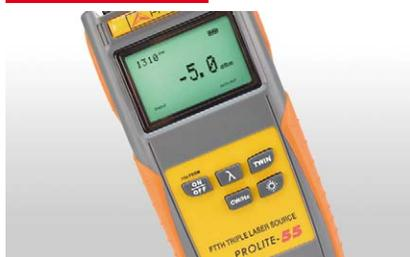
Le **PROLITE-55** émet à 1310, 1490 et 1550 nm avec une excellente stabilité pour tester avec précision la fibre, spécialement en FTTH. Cet instrument compact peut être utilisé soit en mode continu (CW), soit en mode modulé.
