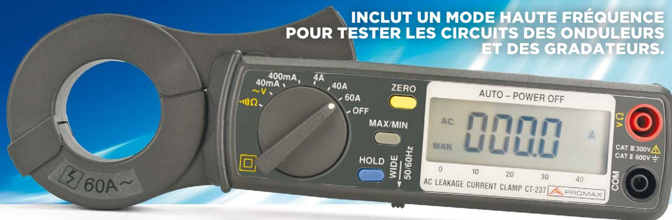
Le **CT-237** est une pince ampèremétrique de précision pour mesurer les courants de fuite, avec une option de sélection du mode de fonctionnement pour les basses fréquences (50/60 Hz) ou élevées (jusqu'à 1 kHz). En mode numérique et en **graphique à barres de 20 échantillons par seconde**. Il est équipé d'un circuit de filtrage spécialement conçu pour éliminer le bruit parasite à haute fréquence et les harmoniques lors de la mesure des courants alternatifs.
