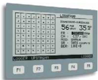
enlace de bajada. En general, un valor de MER bajo puede evidenciar dificultades de funcionamiento del sistema, así como una baja velocidad debido a la pérdida de paquetes y a las interrupciones. La representación gráfica del diagrama de la constelación así como de la tasa de bit erróneos (BER) son otro tipo de medidas muy útiles para la evaluación del rendimiento del enlace de bajada.
