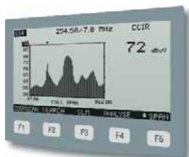
completa de frecuencias (FULL SCAN) como de cada canal sintonizado (ZOOM SCAN), para analizar con detalle cualquier interferencia propia o del canal adyacente.
