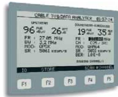
mitida por el módem o atenuación en la banda de retorno. Este último dato es especialmente importante y el instalador debe verificar que este parámetro se encuentra dentro del margen especificado.
