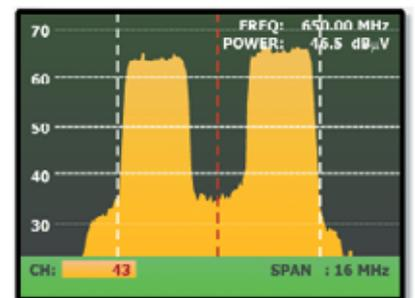
Cavidad espectral que desvela la presencia de productos de intermodulación dentro del canal
