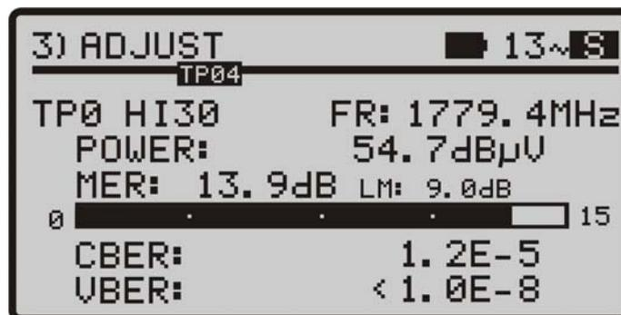
Figure 14.- Écran de mesures de **DVB-S** avec **VBER**.
