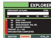
Le TV EXPLORER explore et identifie tous les canaux du plan, et crée un **NOUVEAU PLAN DE FRÉQUENCES** contenant uniquement les canaux où il a trouvé un signal.
