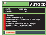
Le TV EXPLORER **identifie** automatiquement s'il s'agit d'un canal analogique ou numérique, ainsi que tous les paramètres nécessaires pour pouvoir démoduler correctement le signal.
